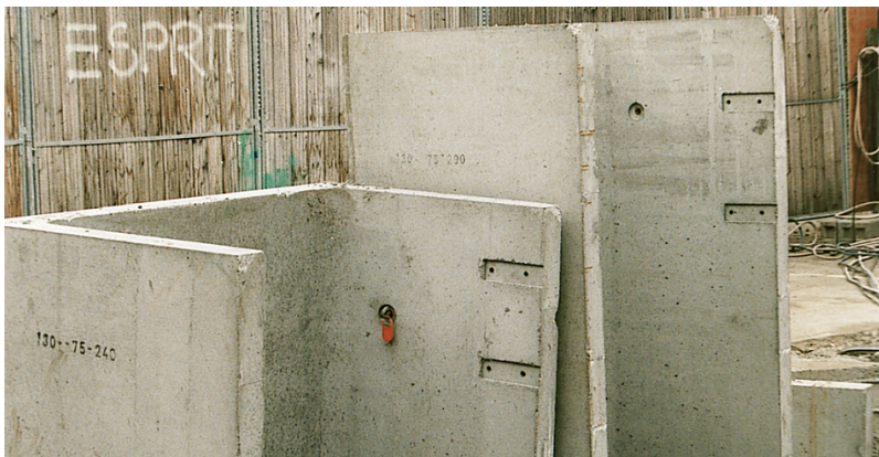
Abb. 1: Stahlbetonfertigteile der Schächte
