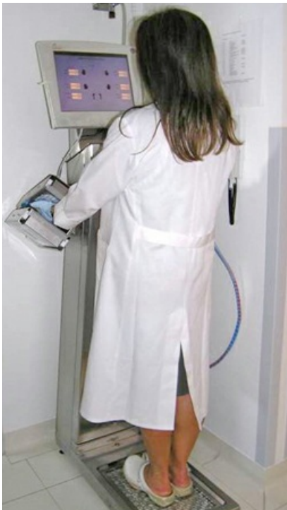
Abb. 2: Kontaminationskontrolle mittels Hand-Fuß-Kleider-Monitor (Bildautor: Paul-Reinhard Bramenkamp)
