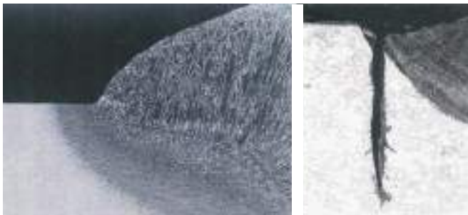
Abb. 12: Kerbwirkung am Nahtübergang – Anriss im Nahtübergang
