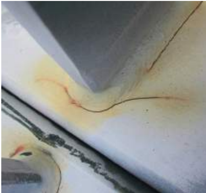
Abb. 15: Typischer Rissverlauf, im Nahtübergang beginnend
