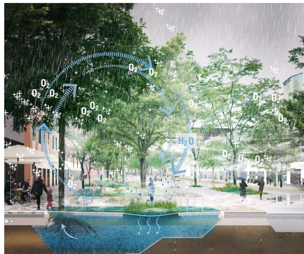
Bilder 2 und 3: Der Boulevard erfüllt klimatische Funktionen wie die Speicherung von Regenwasser und Bewässerung der Pflanzen (Visualisierungen: bauchplan).()
