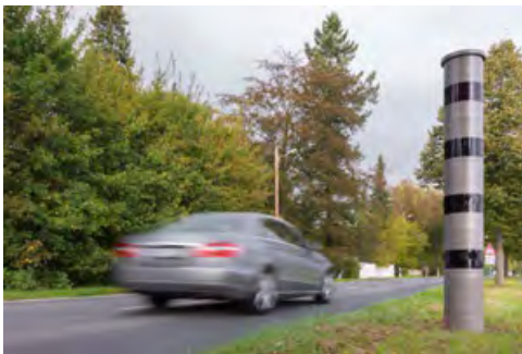
Abb. 5: Stationäres Messgerät: Kamera in Säulenform
