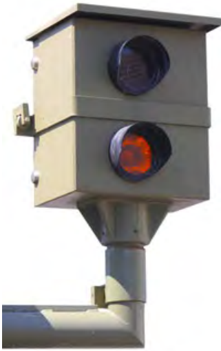
Abb. 4: Stationäres Messgerät: Kamera in Kastenform
