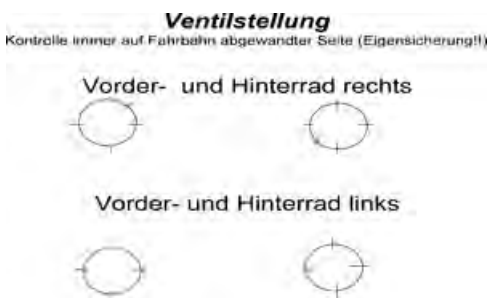
Abb. 3: Räderposition mit eingezeichneter Ventilstellung
